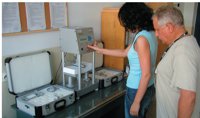
Badanie próbki styropianu pod względem wytrzymałości na zginanie
